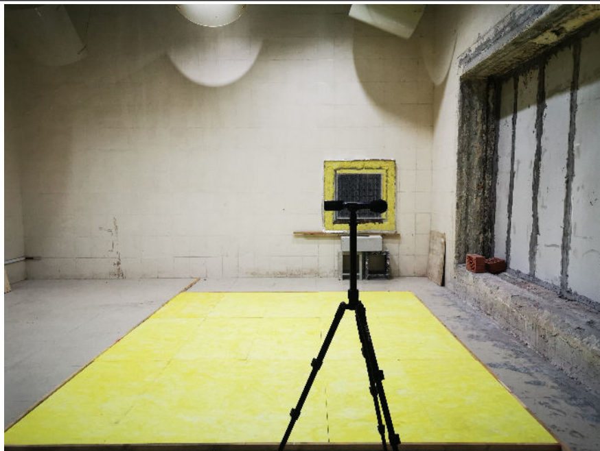
图 3. 玻璃棉板吸声测试布置图
