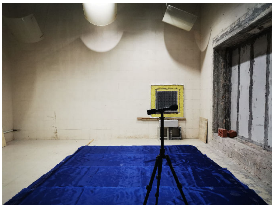
图 4. 剧场专用不燃 A1 级石英纤维透声装饰布软包结构测试布置图
